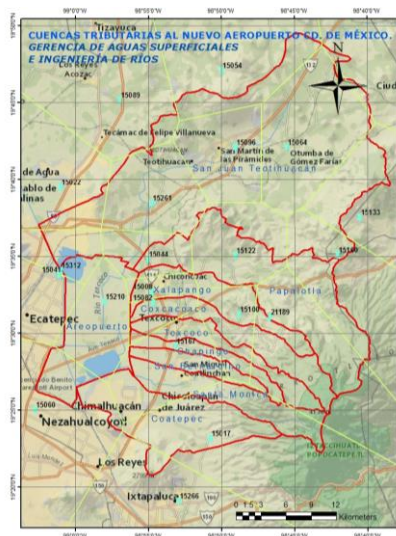
Figura 10 Elaboración de mapa de cuencas tributarias del proyecto Nuevo Aeropuerto, Cd. de México.
