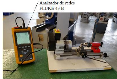
Figura 4 Arreglo experimental para determinar la potencia máxima de mini torno EMCO UNIMAT 4.
