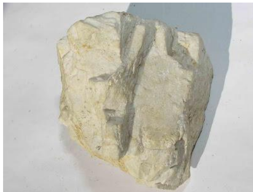
Figura 124. Plagioclase (o Feldespato calcosódico) - (\text{Ca}, \text{Na})\text{AlSi}_3\text{O}_8
