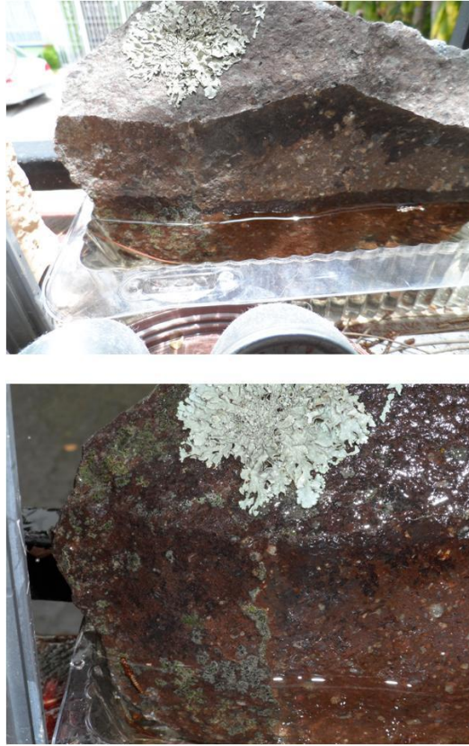
Figura 206 Ascensión capilar roca basáltica
