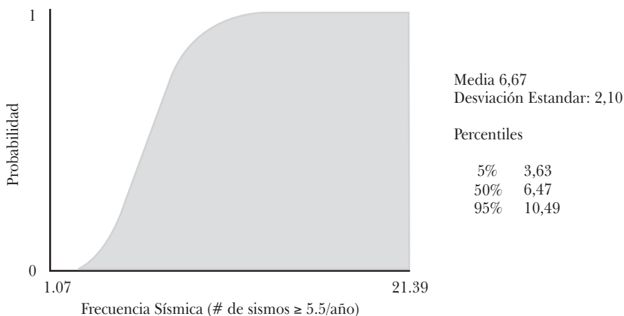
Figura V.1 Distribución acumulada de probabilidad para la variable “frecuencia sísmica” (número de sismos por año mayores a 5.5 grados Richter en la región de interés)
