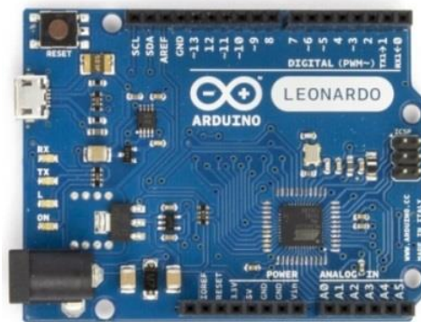
Figura 85. Placa Arduino Leonardo (Dimensiones del PCB: Longitud: 68.6 mm, anchura: 53.3 mm, peso: 20g) (Arduino, 2015)
