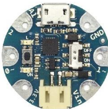
Figura 93. Placa Arduino Gemma (Diámetro: 27.98 mm) (Arduino, 2015)
