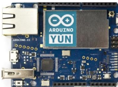
Figura 87. Placa Arduino Yún (Dimensiones del PCB: Longitud: 73 mm, anchura: 53 mm, peso: 32g) (Arduino, 2015)
