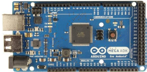
Figura 75. Placa Arduino Mega ADK (Dimensiones del PCB: Longitud: 101.52 mm, anchura: 53,3 mm, peso: 36g) (Arduino, 2015)
