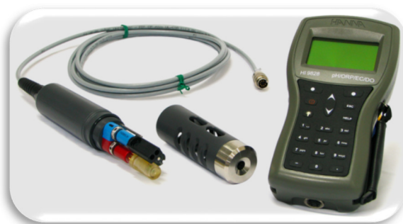
Figura 7. Equipo utilizado: analizador multiparamétrico
