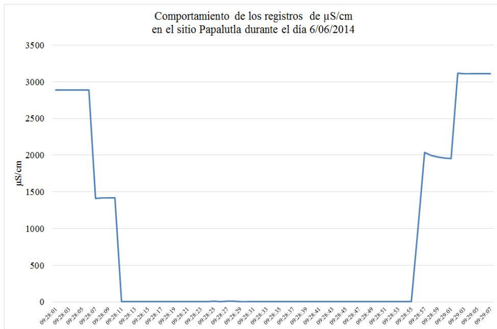
Figura 4. Primeras evidencias de variaciones atípicas de la conductividad del agua durante 58 segundos.
