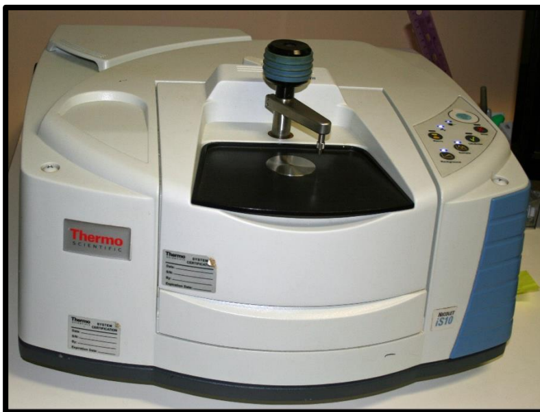
Figura 2.5 Espectrofotómetro FTIR modelo iS10.
