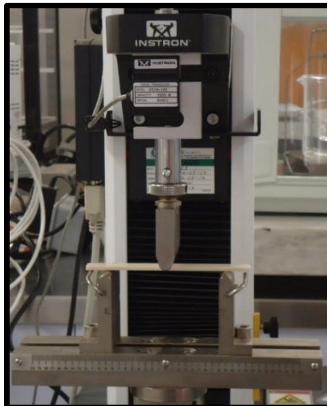
Figura 2.8. Máquina para ensayo de flexión.
