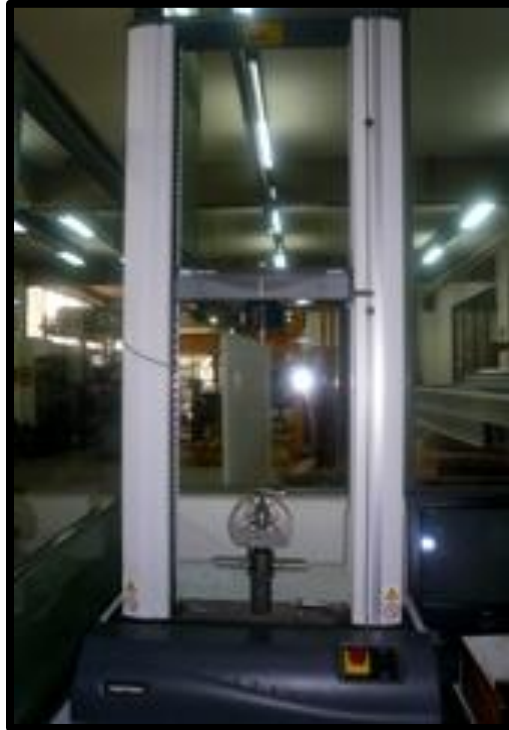
Figura 2.6. Máquina Universal para ensayo de tensión.
