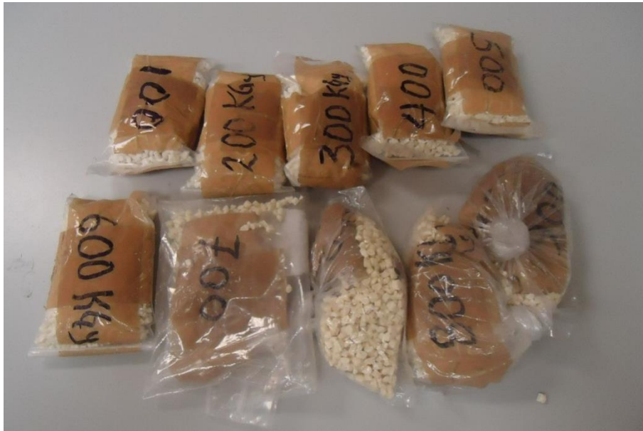
Figura 2.3. Muestras de PP+PLA biodegradable en pelet irradiadas a diferentes dosis.
