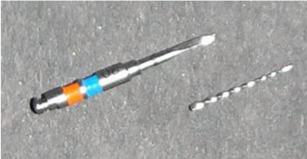
Figura 36. Fractura del instrumento rotatorio.
