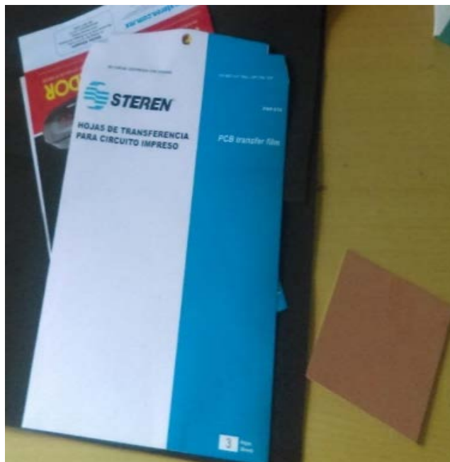
Figura 20. Imprimir el diseño en hojas de transferencia para PCB (Este papel está hecho principalmente de Calcio y está compuesto por hojas con bases de papel de distintos gramajes para adaptarse a los especiales requerimientos de los distintos tipos y modelos de impresoras). (Paso 2).
