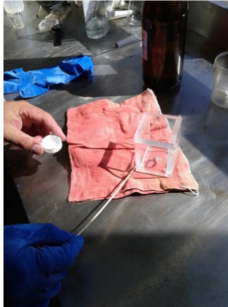
Figura 14. Construcción del recinto para el sensor de vibración; 4 placas de acrílico unidas con cloroformo (Paso 1).
