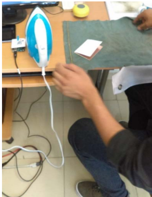
Figura 21. Transferir por medio de calentar con plancha el diseño y la placa fenólica. (Paso 3).
