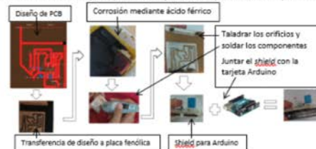
Figura 1. Pasos del procedimiento de construcción del sistema de monitorización de variables físicas y adquisición de datos.
