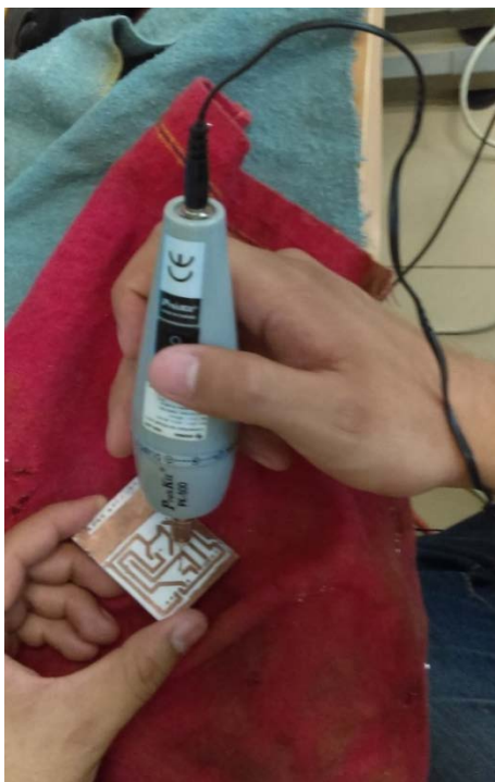
Figura 25. Taladrar en las posiciones correctas. (Paso 5).
