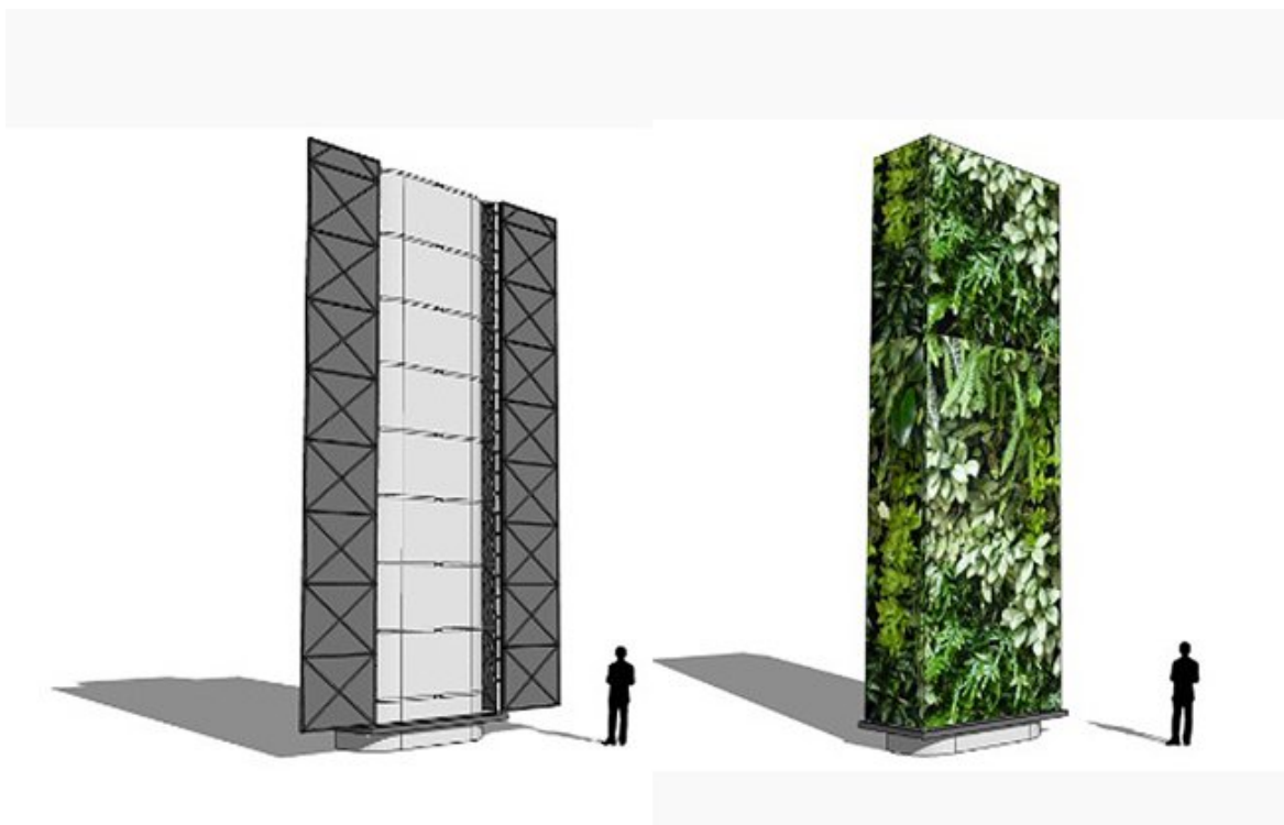
Figura 85. Estructura de los paneles y paneles verdes.
