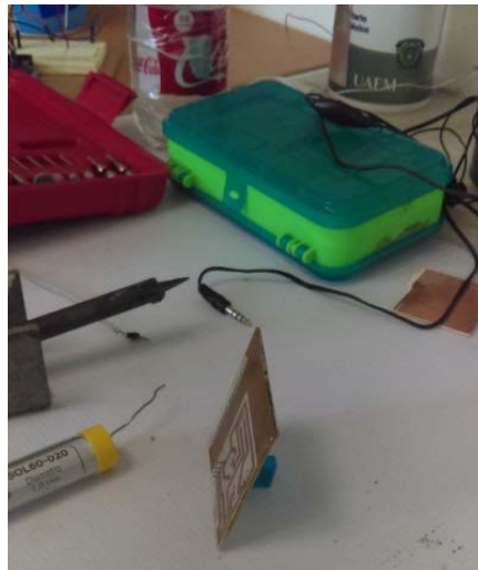
Figura 27. Ubicar cada componente en su posición para después soldar. (Paso 6).
