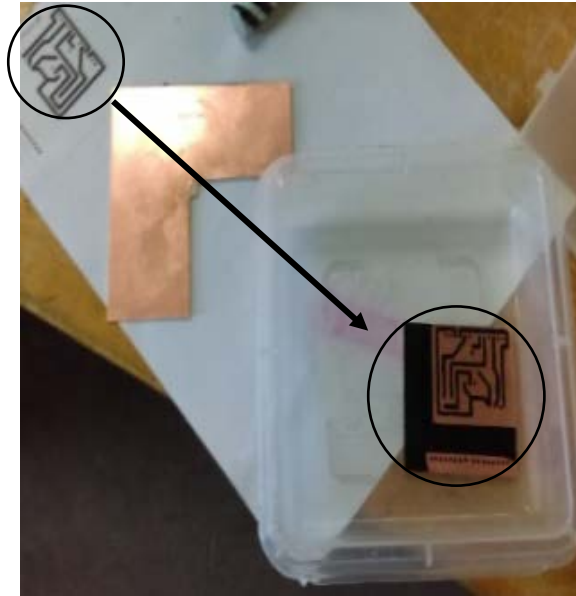
Figura 22. Placa fenólica con diseño de las pistas.
