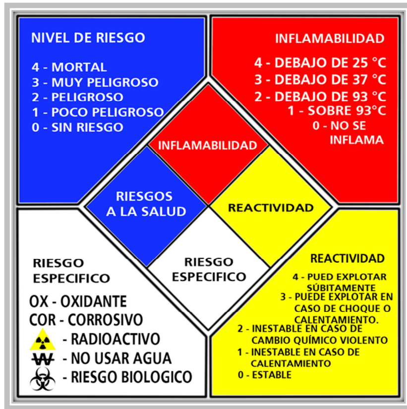
Figura 33. Rombo de seguridad
