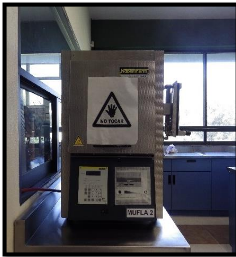
Figura 14. Horno de la marca Naberthem con capacidad de calentamiento de 25-1800°C
