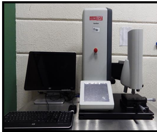
Figura 19. Microdurómetro semiautomático de la marca Emco-Test (Dura Scan 200).
