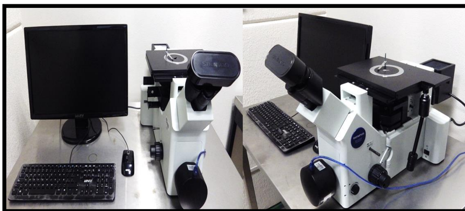
Figura 18. Microscopio óptico metalográfico de la marca Olympus-GX51.
