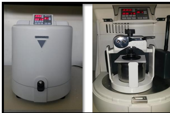
Figura 10. Molino de giro planetario Fritsch Pulverisette 6.
