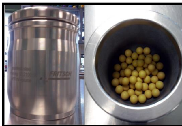
Figura 11. Tazón de acero inoxidable y Medios de molienda de zirconia.
